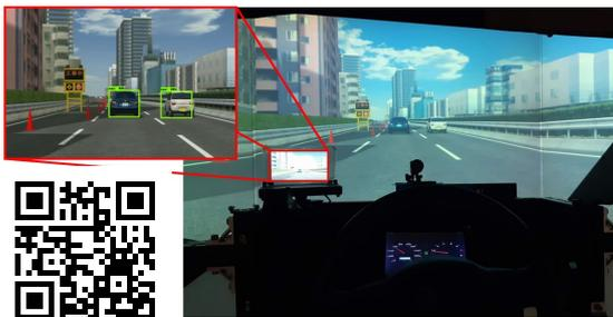
18人の実験協力者に対してドライビングシミュレータ実験を行い、その有効性の評価を行った。システムの認識能力とシステムの挙動について問うアンケートの結果においては、2つのグループ(with HMI, without HMI)の間で、複数の質問項目に対する回答で有意差が見られ、HMIの情報提示によってシステム理解状態の改善を示唆するアンケート結果が得られた。特に潜在リスクに関する項目における有意差が顕著であり、顕在的に体験しない潜在リスクをドライバに意識させ続け、良好なシステム理解状態を醸成する効果が認められた。
